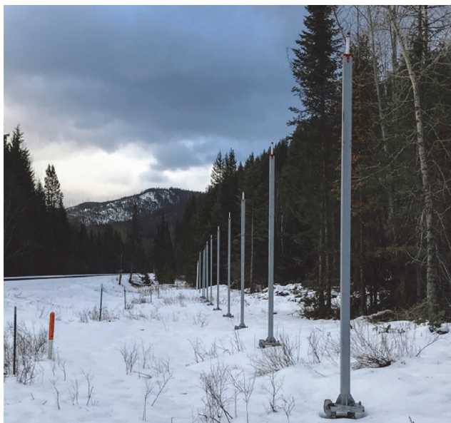
Рис. 1. Установка стоек с датчиками вдоль лавиноопасного участка железной дороги в Северной Америке
